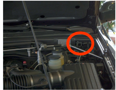
VIN PLATE LOCATION FRONTERA
